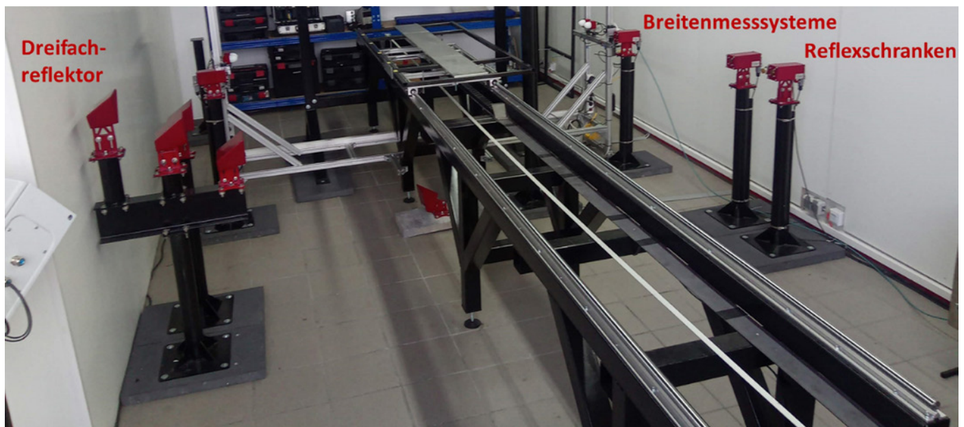
Bild 1. ADLER Radar-Messsysteme im Prüffeld: komplexe Radar-Reflexschranke zur Steuerung von Schopfscheren, einfache Radar-Reflexschranke zur Materialdetektion, Radar-Breitenmesssysteme (Bild: ASINCO)
